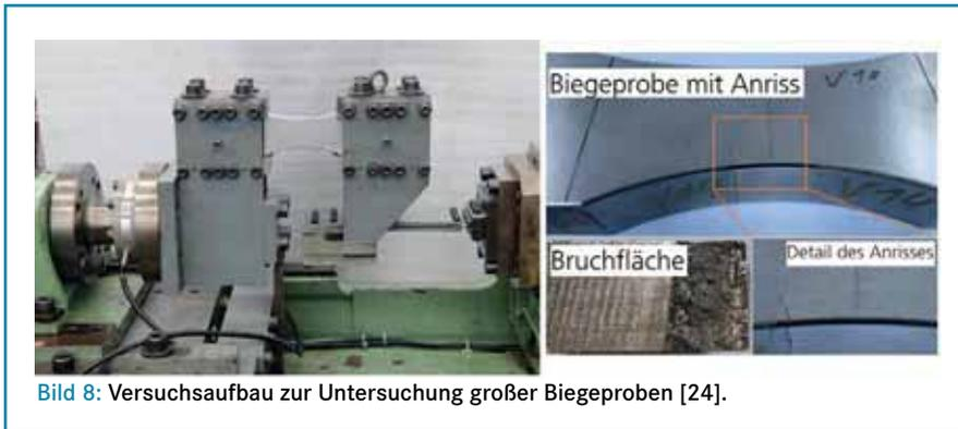
Bild 8: Versuchsaufbau zur Untersuchung großer Biegeproben [24].
