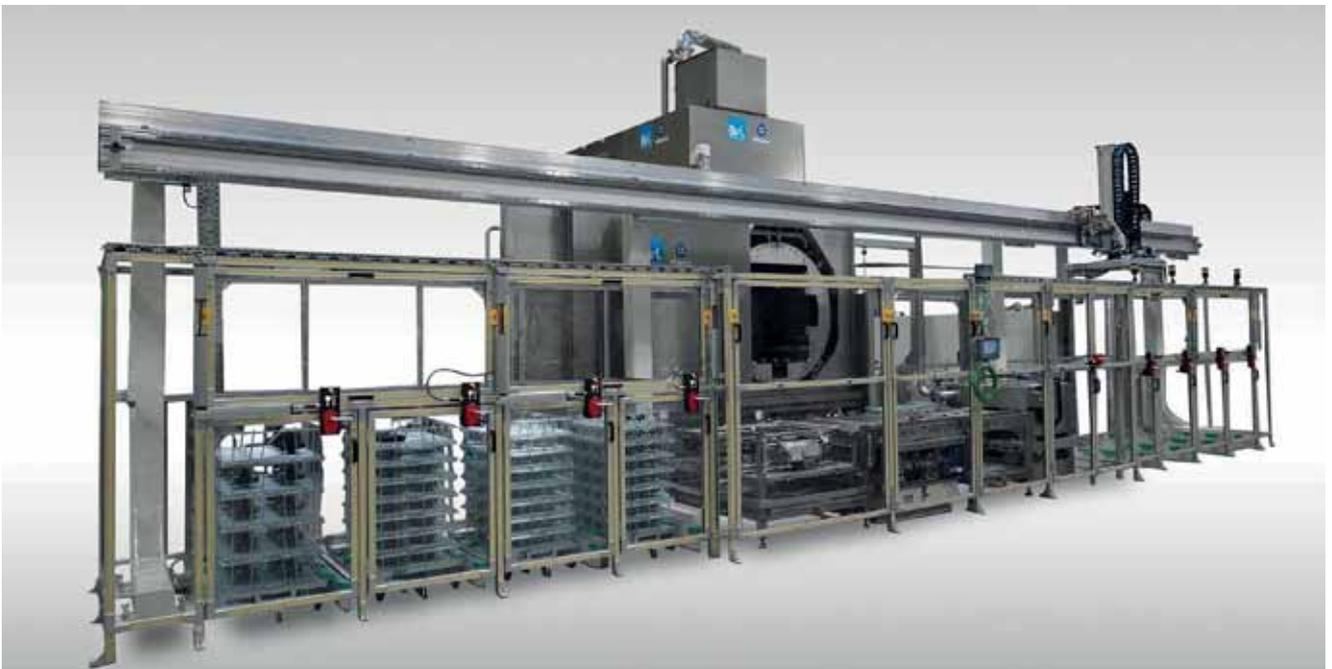
**Bild 1:** Die automatisierte Korbreinigungsanlage Niagara mit Portalsystem.
