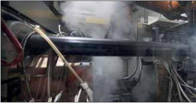
**Bild 1:** Entstehender Sprühnebel bzw. Rauch während des Sprühvorgangs im Druckgießprozess.
