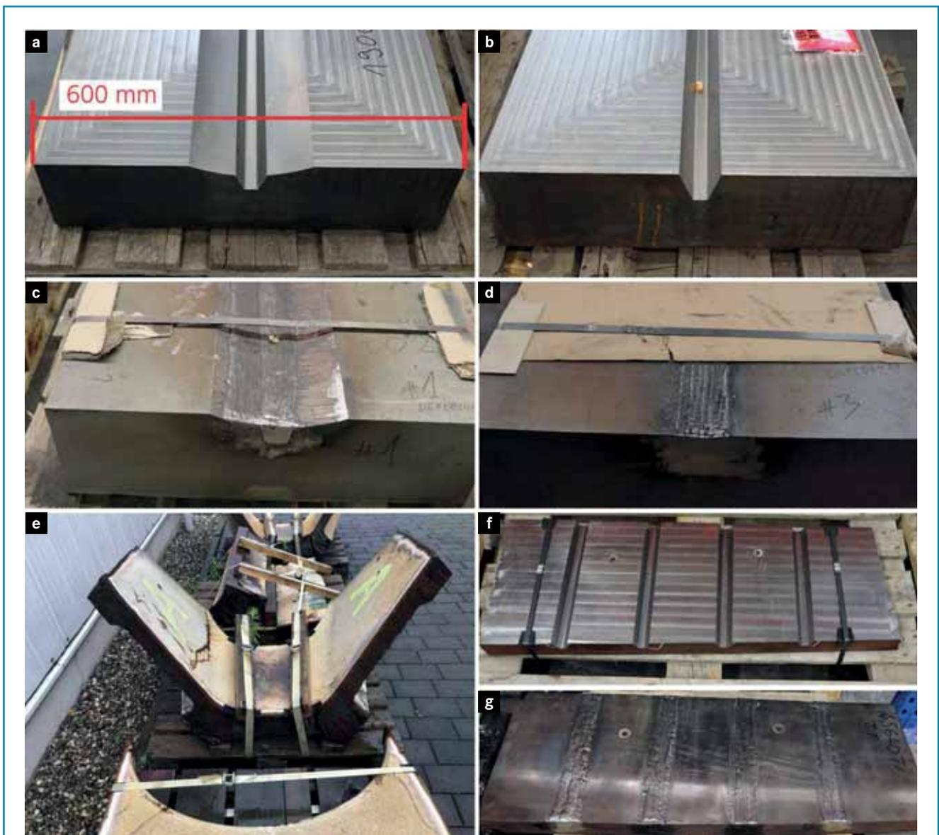
**Bild 1:** a) Gussplatte mit gefräster Nut für die Entnahme von Biegeproben, b) Gussplatte mit gefräster Nut für die Entnahme von Axialproben, c), d) geschweißte Gussplatten, e) Bauteilsegmente der Rotornabe; f) Bauteilsegment mit eingebrachter Nut, g) Bauteilsegment mit geschweißter Nut.
