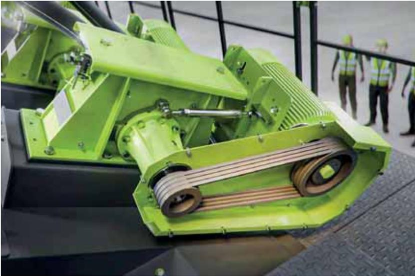
**Bild 1:** Strahlmaschine TSM V mit 30 kW Antriebsleistung.
