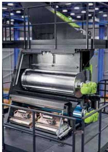
**Bild 2:** Veranschaulichung Magnetabscheider.
